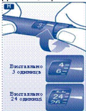
Виставлена доза може бути відкоригована у бік збільшення або зменшення обертанням селектора дози у відповідному напрямку, поки необхідна доза не буде збігатися з покажчиком дози. При обертанні селектора у бік зменшення дози стежте за тим, щоб випадково не натиснути на пускову кнопку, тому що це призведе до витікання інсуліну.
